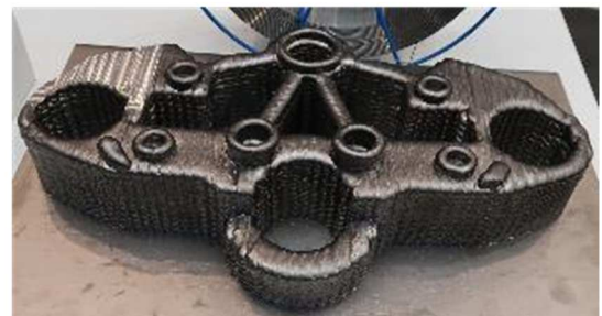
Obr. 3: Nový navařovací stroj firmy GEFERTEC který navařuje díly z kovu pomocí elektrického oblouku (bez obrábění).
