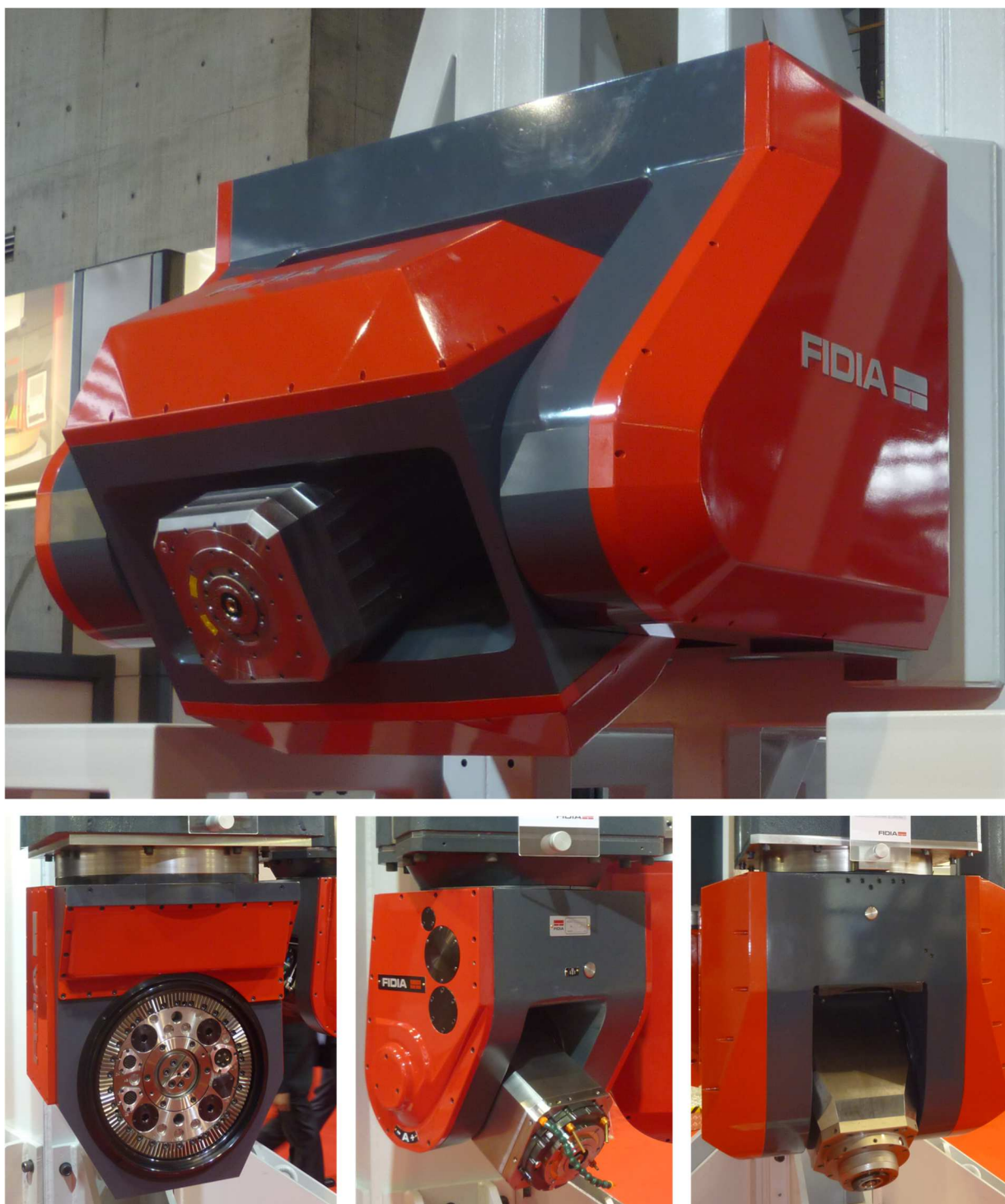
Obr. 1: Plejáda výměnných frézovacích hlav strojů FIDIA.
