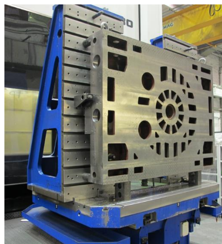
Těleso saní upnuté na úhelníku, na kterém byla analyzována možnost zvýšení produktivity obrábění.
