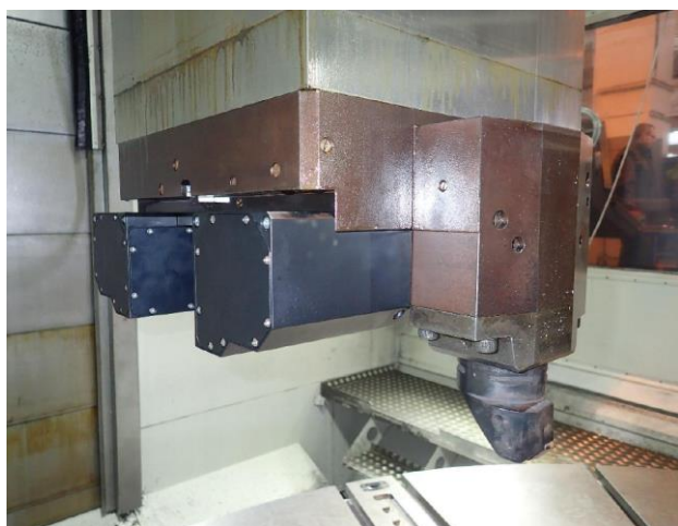
Soustružnický adaptér s integrovaným hltičem na karuseli TOSHULIN
