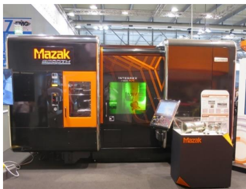
Obr. 3: Nový stroje Mazak pro hybrid manufacturing integrující technologii AM do obráběcího stroje. Stroj nabízí dvě laserové navařovací hlavy – hrubovací a dokončovací.
