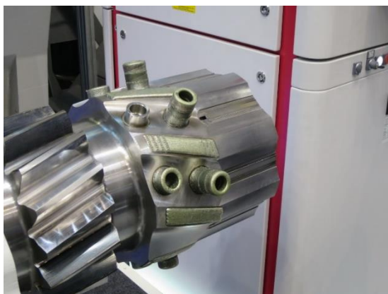
Obr. 1: Návar Inconelu na nerezovou ocel provedený na stroji WFL
