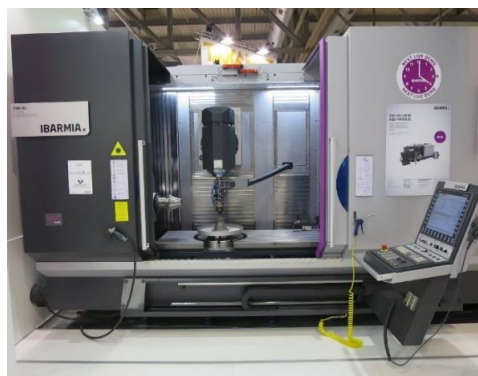
Obr. 4: Pohled do pracovního prostoru stroje pro hybrid manufacturing z nabídky španělské firmy IBARMIA
