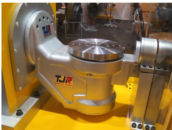
Obr. 9: Nabídka stolu pro frézování i soustružení se super high speed prstencovým motorem a s maximálními pracovními otáčkami 2500 za min
