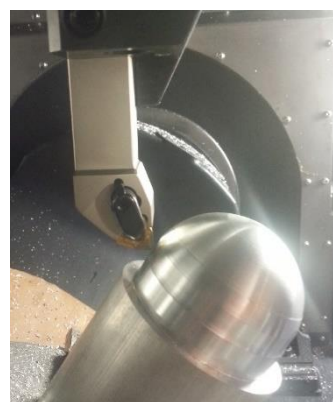
Základní technologické možnosti stroje KOVOSVIT MAS MCU700VT-5X, které vyvinutý postprocesor umožňuje plně využít – frézování, soustružení karuselováním, soustružení s naklopenou osou A, soustružení s plynulým naklápěním osy A.
