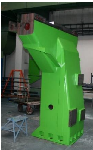
Realizovaný stojan stroje FRF firmy TOS KUŘIM s optimalizovanou vnitřní strukturou
