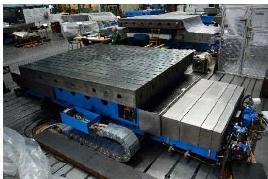
Otočný stůl TVD50 firmy Škoda Machine Tool s optimalizovanou strukturou a hydrostatickým vedením
