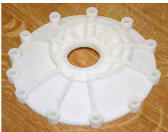
Obr.10 Prototyp veka prevodovky vyrobený metódou RP FDM [8]
