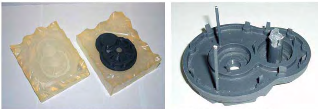
Obr.13 Hotový odliatok odliaty do silikónovej formy [8]
