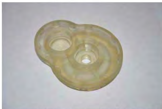
Obr.11 Prototyp veka prevodovky zhotovený metódou SLA [8]
