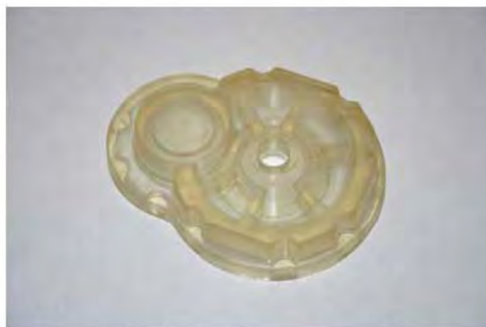
Obr.11 Prototyp veka prevodovky zhotovený metódou SLA [8]
