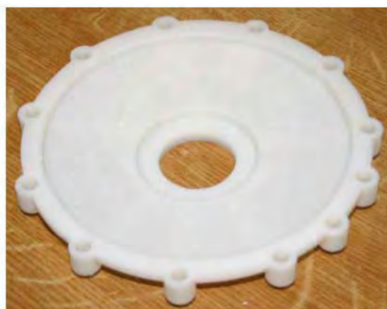
Obr.10 Prototyp veka prevodovky vyrobený metódou RP FDM [8]
